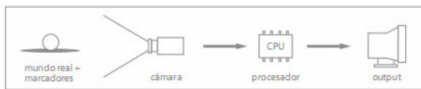
Figura 2.2: Representación del funcionamiento básico de la realidad aumentada
